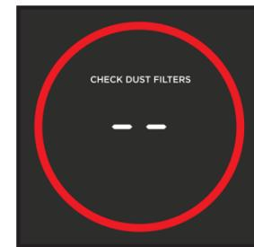
**Opomba:** Če želite ročno ponavljati indikator Check Dust Filters, pritisnite in držite ikono filtra na zgornji nadzorni plošči 1-2 sekundi.
