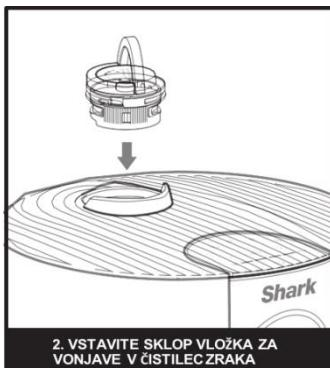
2. VSTAVITE SKLOP VLOŽKA ZA VONJAVE V ČISTILEC ZRAKA
